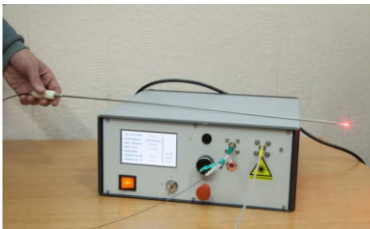
Рисунок 238. Фотография опытного образца лазера на керамике Tm:Lu_2O_3 с волоконным выходом для отоларингологии.
