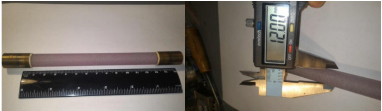
Рисунок 105. Фотографии лазерных стержней \text{Ø}12 \times 135 мм производства компании “Laser Materials Corp.”, США.
