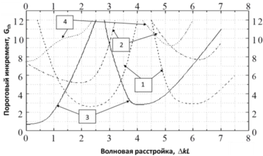
Рисунок 40. Зависимость порога генерации G_{th} волны рассеяния от расстройки четырехволнового синхронизма \Delta kl для взаимной петли с r_{21} = r_{43} = 1 при al \ll 1 (1), с r_{21}^2 = r_{43}^2 = 0.95 при al = 1 (2), для невзаимной схемы с \Delta\varphi = \pi/2 , r_{21} = r_{43} = 0.75 и al \ll 1 (3), для спекл-неоднородной волны с \Theta/\Theta_d=1 во взаимной схеме с r_{21}^2 = r_{43}^2 = 0.95 , al \ll 1 (4).
