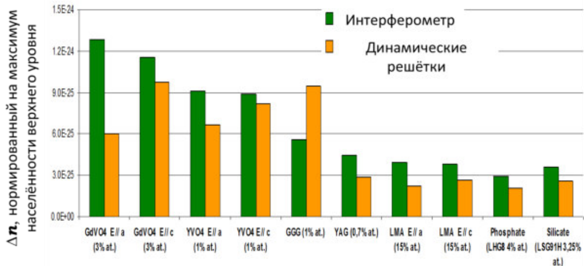
Рисунок 23. Гистограмма измеренных ИПП при накачке на 808 нм, нормированных на величину максимальной инверсной населённости (в конце импульса накачки), для Nd-содержащих кристаллов и стёкол, измеренные с помощью интерферометра (зелёные) и тестирования динамической решётки (жёлтые). Указывается направление вектора поляризации электрического поля тестирующей волны относительно кристаллографических осей кристаллов, концентрация ионов \text{Nd}^{3+} в атомарных %.
