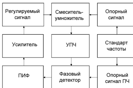
Рис. 2.4. Схема системы ФАПЧ с супергетеродинным приемником.
