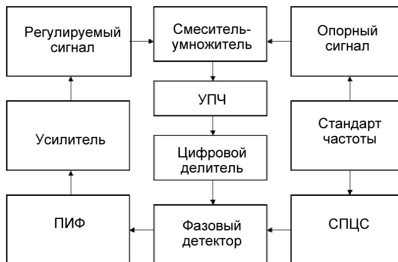
Рис. 2.6. Система ФАПЧ, обеспечивающая быстрое сканирование частоты регулируемого сигнала без фазовых скачков при переключениях в пределах полосы пропускания УПЧ.
