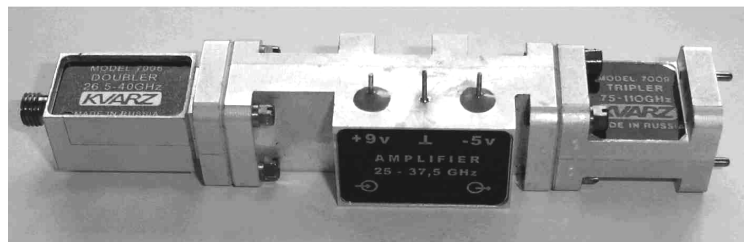
Рис. 2.17. Умножитель частоты микроволнового синтезатора, использованного в системе ФАПЧ диапазона 350—520 ГГц.
