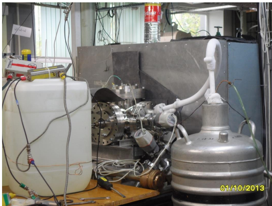
Рисунок 4.5. Внешний вид диагностической камеры с установленной мишенью и системой прокачки сжиженного азота.
