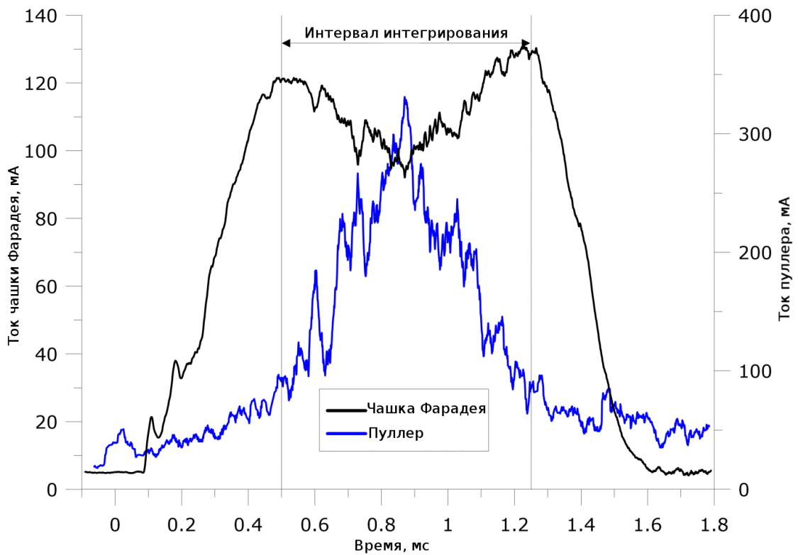
Рисунок 3.39. Осциллограммы тока на цилиндр Фарадея (верхний оранжевый луч) и на пуллер (нижний синий луч). Ускоряющее напряжения 55 кВ. Апертура плазменного электрода, апертура пуллера и межэлектродное расстояние 5, 10 и 11 мм соответственно.
