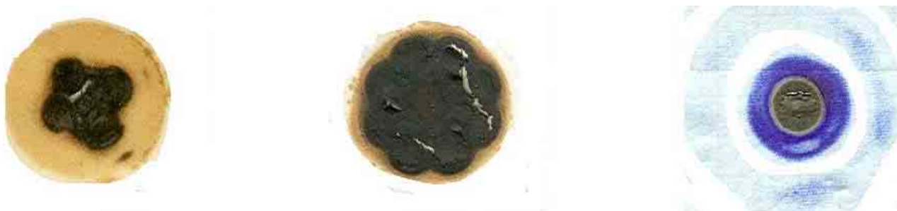
Рисунок 3.14. Поперечная структура поля на выходе из окна гиротрона для некоторых мод ( TE_{-2,3} , TE_{4,2} , TE_{0,3} ).
