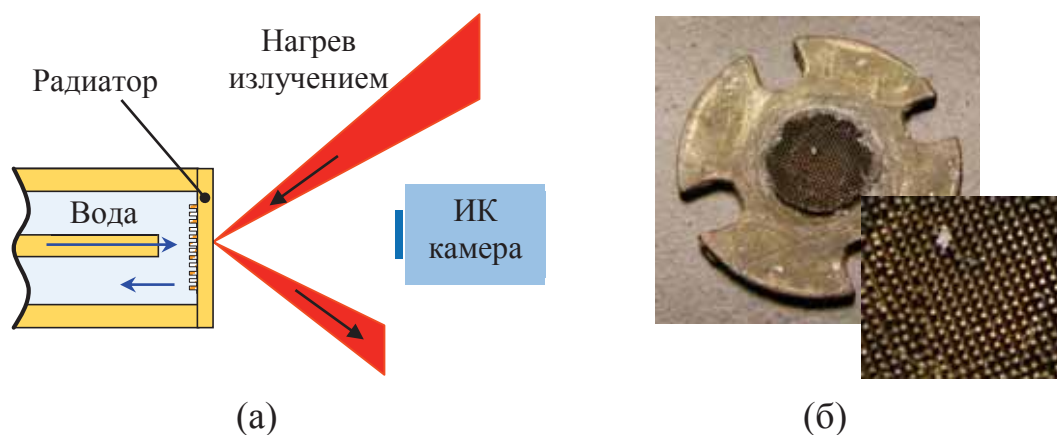
Рис. 5. (а) Система охлаждения радиатора и схема измерения коэффициента теплоотдачи. (б) Фотография радиатора с мелкомасштабной насечкой.
